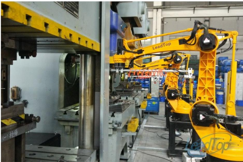
明光利拓智能科技有限公司的冲压连线全自动生产线的特点：四台机器人实现冲压连线，机器人搬运，节省人力，连线生产，提高生产效率，防止工伤。冲压连线自动化作业主要是通过多台冲压机械手在多台压力机之间建立冲压连线。根据加工工件成形工艺要求，需要在多台压力机配合加工。
